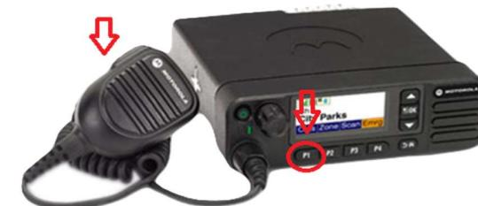
En caso de emergencia debe presionar el botón programable P1 de la radio base por 3 segundos, lo que automáticamente cambiara al canal 5 (Prevención), teniendo contacto directo con la llamada de emergencia,
